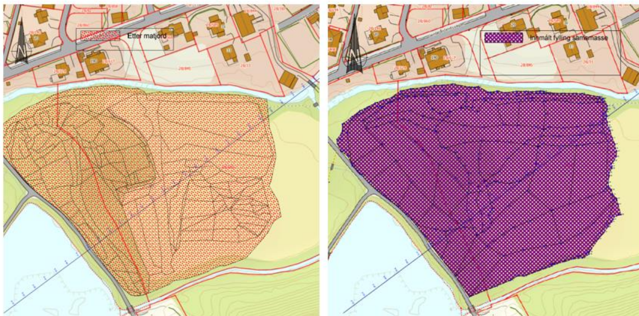
Figur 4. Venstre: innmålinger på tomten etter fjerning av matjord og bløte masser i toppen, høyre: innmålt topp fylling av stedlige friksjonsmasser fra voll (T1, T2-masser).
